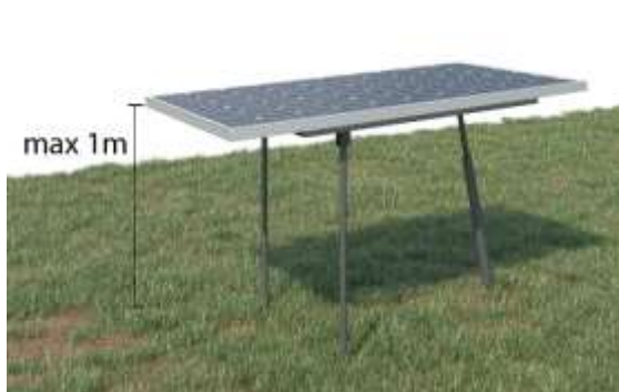
Slika 21: Primer umestitve fotonapetostne naprave na raščeni teren s prikazom najmanjšega in največjega predpisanega odmika od terena
