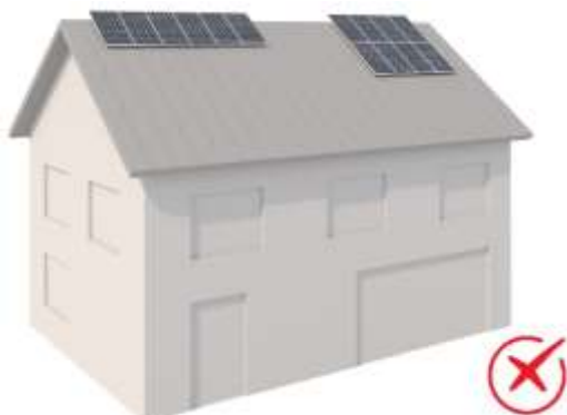
Slika 13: Primer neustrezne postavitve fotonapetostnih modulov na streho, saj so višji od slemena
