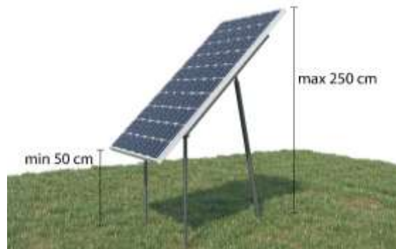
Slika 21: Primer umestitve fotonapetostne naprave na raščeni teren s prikazom najmanjšega in največjega predpisanega odmika od terena
