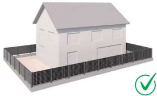
Slika 20: Primer ustrezne in usklajene umestitve fotonapetostnih naprav kot ograja ob stavbi
